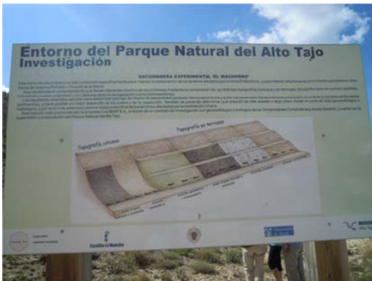
Panel explicativo de los diferentes métodos experimentales de restauración de talud que se han llevado a cabo en la mina El Machorro.
